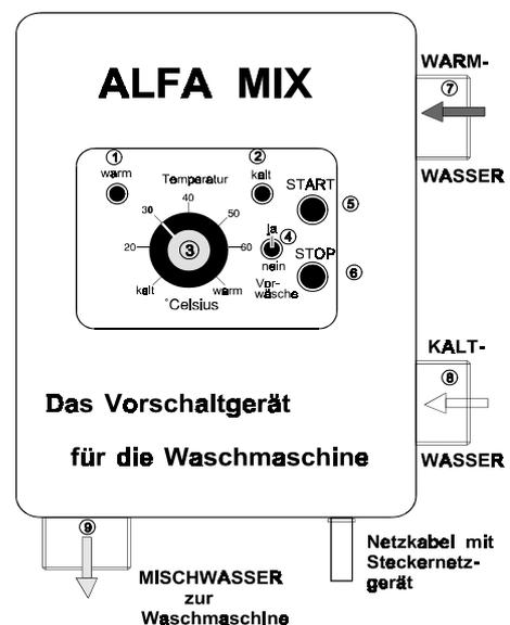
Nach 2 Std. 30min schaltet sich ALFA MIX selbsttätig ab, die grüne Kontrollleuchte erlischt. (Diese Laufzeit ist werksseitig eingestellt und kann im Bedarfsfall intern verändert werden – Einstellbereich: 2 – 3 Std.)
